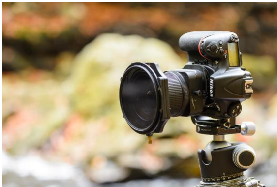
NIKKOR PC-E 24mm f/3.5D tilt-shiftlens in actie. Tilt en shift worden hier gecombineerd.
